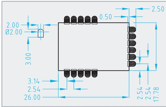
Bild 5: Layoutvorgabe für das CP2102-Modul (Maßangaben in mm)
