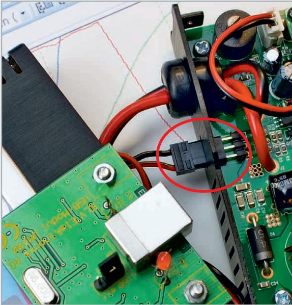
**Bild 2:** Einsatz des in vielen Geräten eingesetzten ELV UM 100 an der seriellen Schnittstelle eines Modellbau-Ladegerätes. Das hier verwendete USB-UART-Modul könnte durch das viel kompaktere UM 2102 ersetzt werden.
